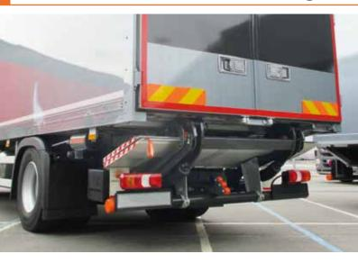
La DH-RM.20 está diseñada con un robusto bastidor, un centro de brazos amplio y 2 cilindros de elevación. Por lo tanto es la **solución perfecta** para **las cargas pesadas dentro del mercado de las plataformas replegables**. Esta plafaforma viene de serie con plato en forma de cuña con un recorrido horizontal desde el piso del vehículo al suelo (y viceversa), **incluyendo la inclinación automática a nivel de suelo**.
