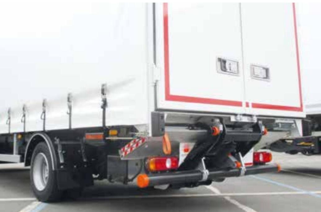
La DH.RC.10 es la plataforma más vendida de DHOLLANDIA dentro del rango de plataformas ligeras replegables. A diferencia de la DH-RP, esta plataforma viene de serie con plato en forma de cuña con un **recorrido horizontal desde el piso del vehículo al suelo** (y viceversa), incluyendo **la inclinación automática a nivel de suelo**.
